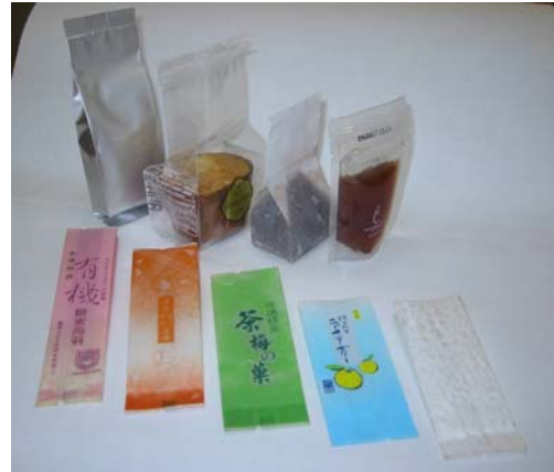
自動成形に成功した様々なタイプのガゼット袋やパウチ袋
