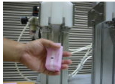
④ ペダルを放して袋を抜き取ります。
